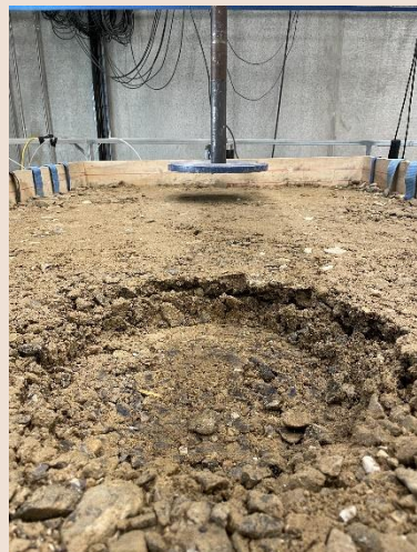
Trykket efter belastning med 1.000 cyklus på 10 sek. I hhv. 12 og 30 kN
