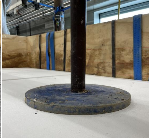
Flamingo, ekspanderet polystyrenskum, EPS simuleret blødbund
