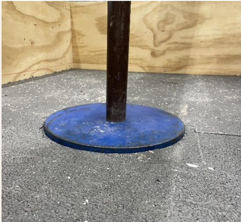
Flamingo, ekspanderet polystyrenskum, EPS simuleret blødbund
