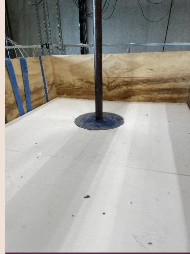
Test af planum med hydraulisk cylinder
