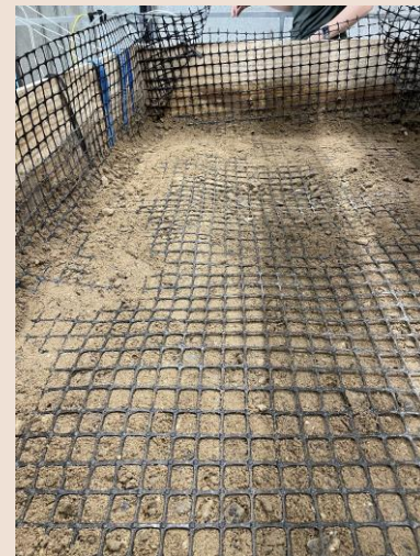
Geonet efter forsøg
