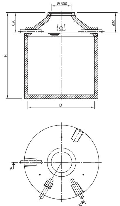
\* Ved diameter Ø3000 er keglen med 2 stk. DN150 til- og afløb, tilløbsdybde = 550 mm - ikke tung trafiklast
