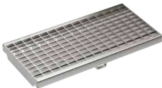
Nätgaller, galvaniserad, rostfritt stål Belastningsklass: C250 , Längd: 50 cm, 100 cm, MW 30 x 20 mm / 20 x 20 mm
