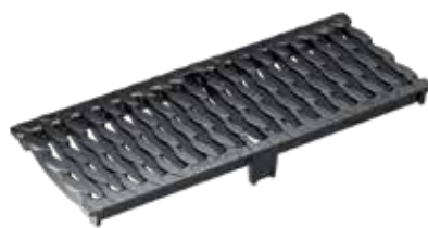
Slitsat galler med OvalGrip Design, segjärn GJS, KTL-behandlad Belastningsklass: D400*, E600* Längd: 50 cm, SW 12 mm
