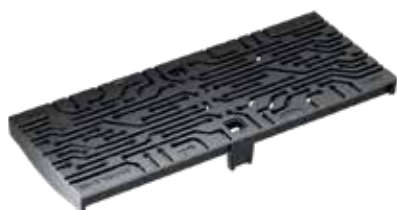
Design galler, WIRE, segjärn GJS, KTL-behandlad Belastningsklass: D400* Längd: 50 cm, SW 5 mm
