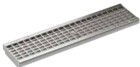
Nätgaller, galvaniserad, rostfritt stål Belastningsklass: B125, C250, D400 , Längd: 50 cm, 100 cm MW 30 x 14 mm / 30 x 10 mm / 20 x 14 mm
