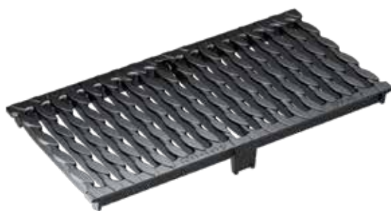
Slitsat galler med OvalGrip Design, sej järn GJS, KTL-behandlad Belastningsklass: D400* , E600* , Längd: 50 cm, SW 12 mm
