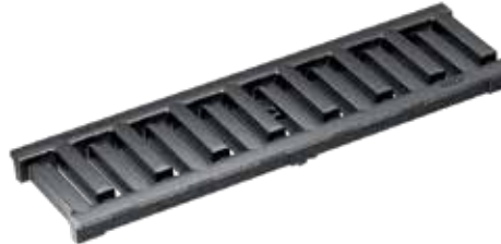
Slitsat galler, MASSIV 32, segjärn, KTL-behandlad Belastningsklass: E600* , Längd: 50 cm, SW 11 mm Passar endast för KE-100.
