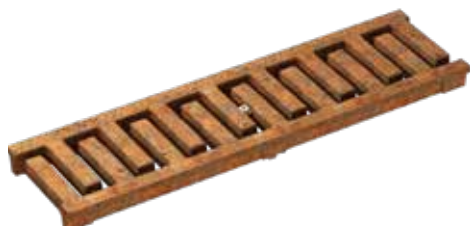
Slitsat galler, MASSIV 32, segjärn, obehandlad Belastningsklass: E600* , Längd: 50 cm, SW 11 mm Passar endast för KE-100.
