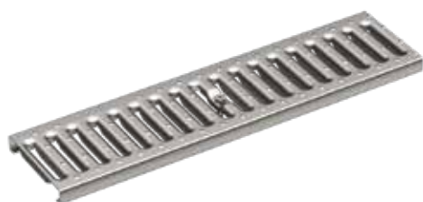
Slitsat stål-galler, Förstärkt slitsad stål-galler, galvaniserad, rostfritt stål, Belastningsklass: A15, C250 , Längd: 50 cm, 100 cm, SW 10 mm
