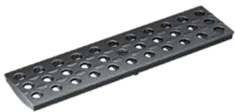
Design galler, CIRCLE, GJS segjärn, KTL-behandlad Belastningsklass: D400 , Längd: 50 cm, Ø 19,5 mm
