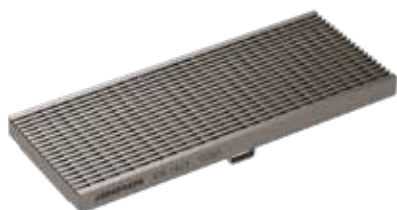
Längsgående galler, rostfritt Belastningsklass: C250 Längd: 50 cm, 100 cm, SW 5 mm
