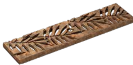
Design galler, LEAF, segjärn, obehandlad Belastningsklass: C250 , Längd: 50 cm, SW 5 - 9 mm
