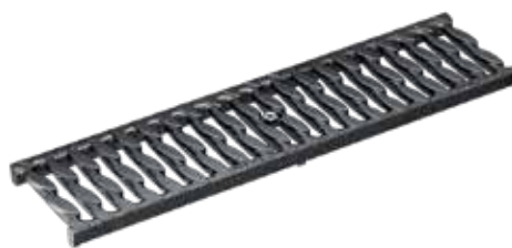
Slitsat galler, OvalGrip Design, seggjärn, KTL-behandlad Belastningsklass: C250, E600* , Längd: 50 cm, SW 10 mm
