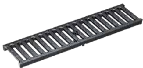
Slitsat galler SW 10, seggjärn, KTL-behandlad Belastningsklass: C250 , Längd: 50 cm, SW 10 mm
