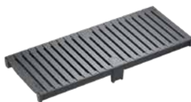
Slitsat galler, HEELGUARD, segjärn GJS, målad svart Belastningsklass: D400* Längd: 50 cm, SW 6 mm
