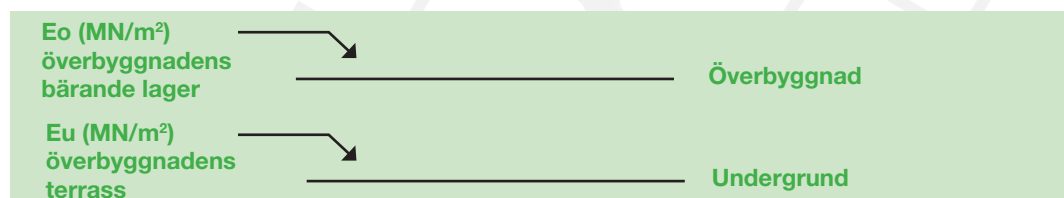
Figur 4 Plattbelastning på bärlagrets övre yta respektive jordterrassens övre yta
