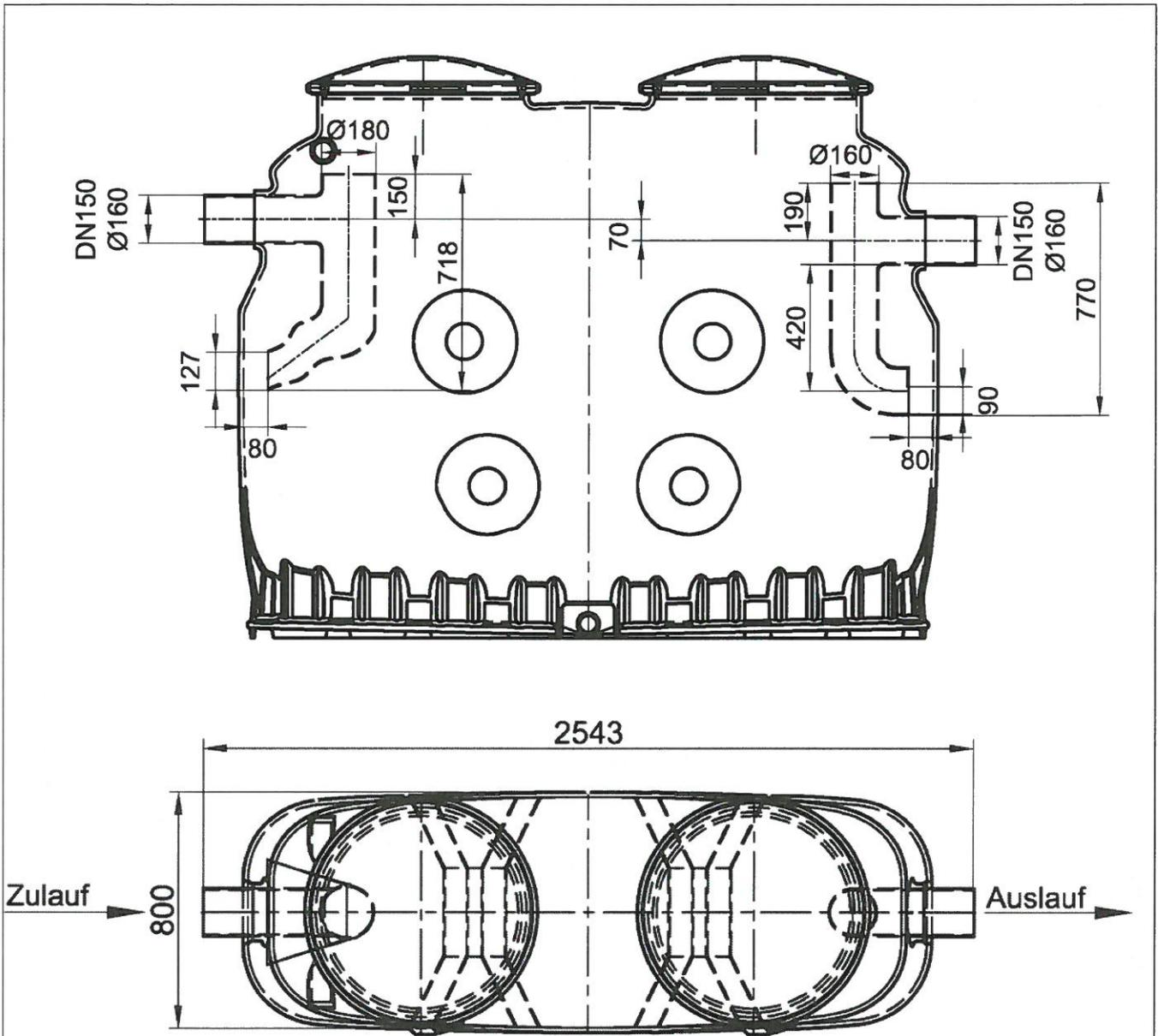
Abscheideranlage für Fette aus Kunststoff bestehend aus einem Abscheider und einem Integrierten Schlammfang, MAGUS Rho
