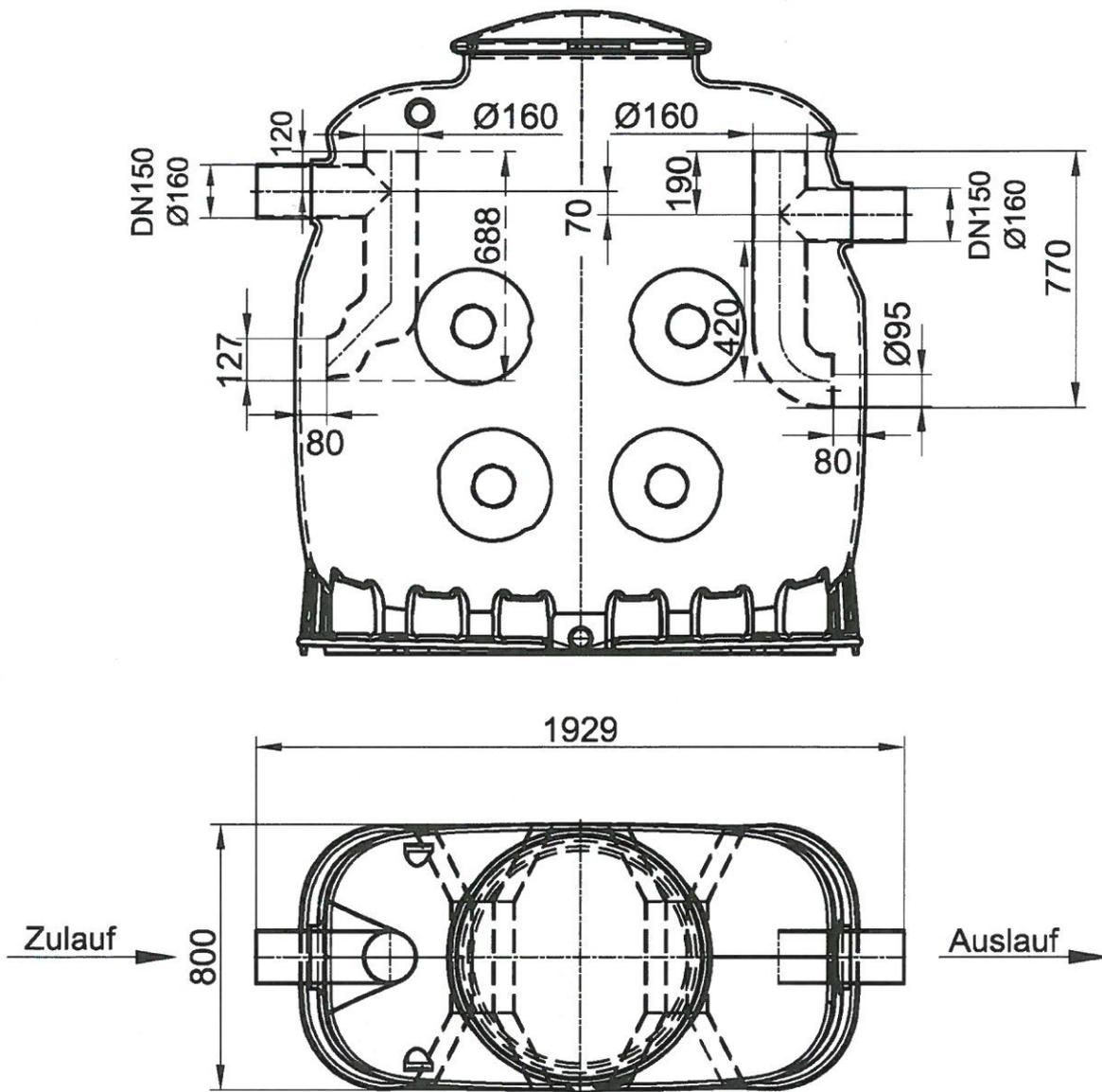
Abscheideranlage für Fette aus Kunststoff bestehend aus einem Abscheider und einem Integrierten Schlammfang, MAGUS Rho
