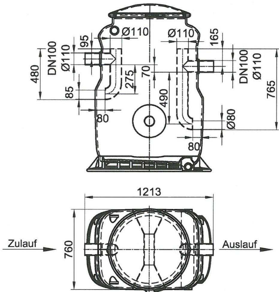
Abscheideranlage für Fette aus Kunststoff bestehend aus einem Abscheider und einem Integrierten Schlammfang, MAGUS Rho
