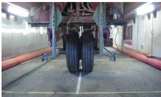
Tensar har gennemført laboratorieforsøg og adskillige fuldskalaforsøg over mange år med det formål at evaluere stabiliseringseffekten af Tensar geonet i fleksible belægninger.
